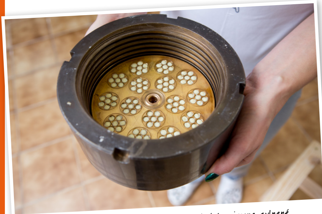
Špeciálnu matricu na tenké dlhé ploché a jemne zvlnené rezance vyrobili z kolienkovej.
